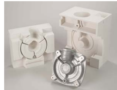
Mit ZCast 3D-Drucken hergestellte Form und gegossenes Aluminiumteil
