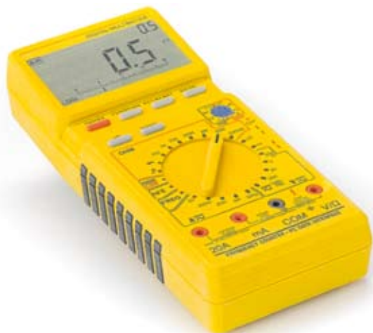
Rekordhalter: Diesen Prototyp eines bunten Handheld-Messgeräts fertigt der neue Z Printer 650 von Z Corporation in etwa einer Stunde. (Bild: 4D Concepts/ Z Corporation)
